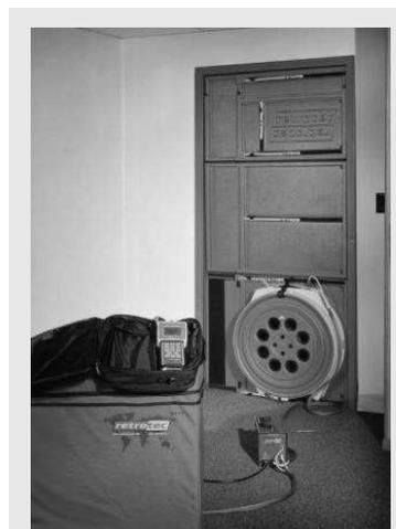
Figure 5.2 Installation d'un infiltrmètre (image reproduite avec l'aimable autorisation de Retrotec Energy Innovations Inc., Vancouver).
